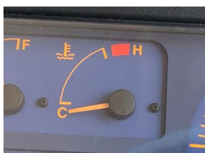
水温計 冷却水の温度を教えてくれる
