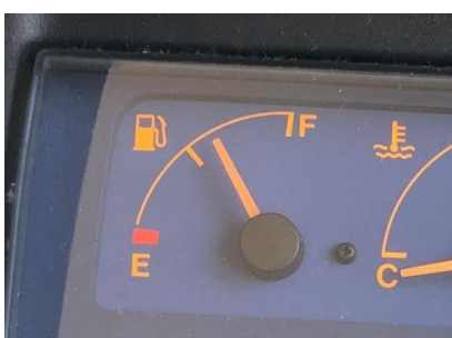
燃料計 燃料の残量を教えてくれる
