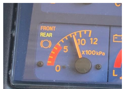
空気圧力計 空気圧がないとバスは走れない
