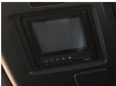
バックアイモニター バス後ろのカメラの映像をうつす
