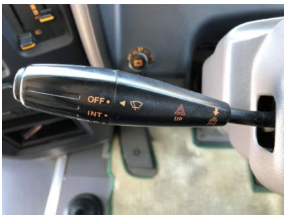
ハザードスイッチ 左右同時に方向指示器が点滅
