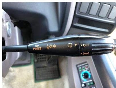
ウインカースイッチ 上と下で、左右の方向指示器が点滅
